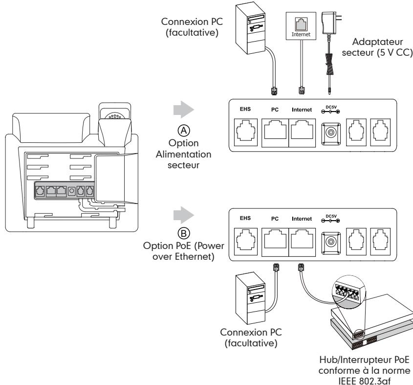
**Remarque :** Le téléphone IP doit seulement être utilisé avec l'alimentation Yealink (5V/1.2A) d'origine. L'utilisation d'un adaptateur secteur tiers peut endommager le téléphone.
